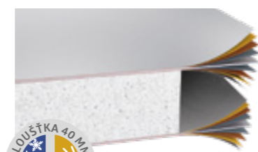
Izolovaná boční stěna / dveřní panel Navrstvený prvek s jádrem polystyrenu 40 mm (EPS W20)
