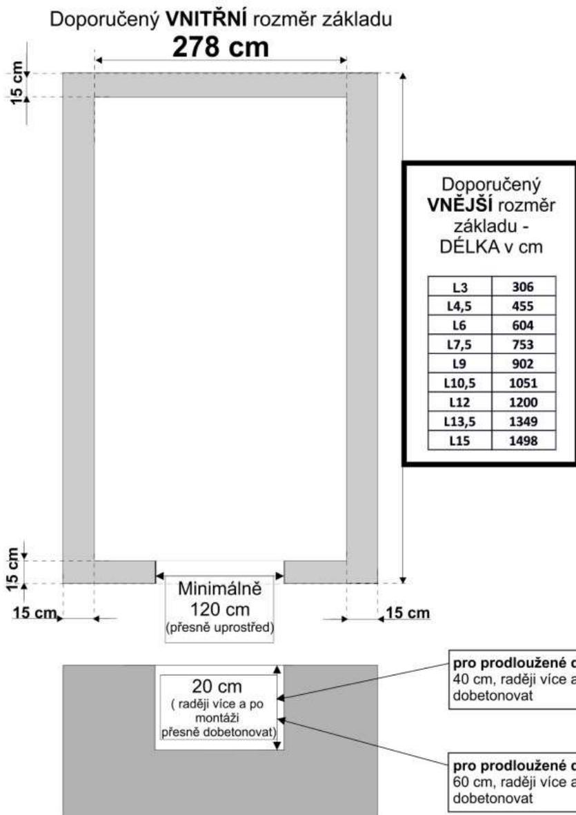
Doporučujeme pevné betonové základy ( lze použít i ztracené bednění). Pouze v případě řádného ukotvení skleníku k pevným základům lze dát plnou garanci za stabilitu skleníku dle statických výpočtů.
