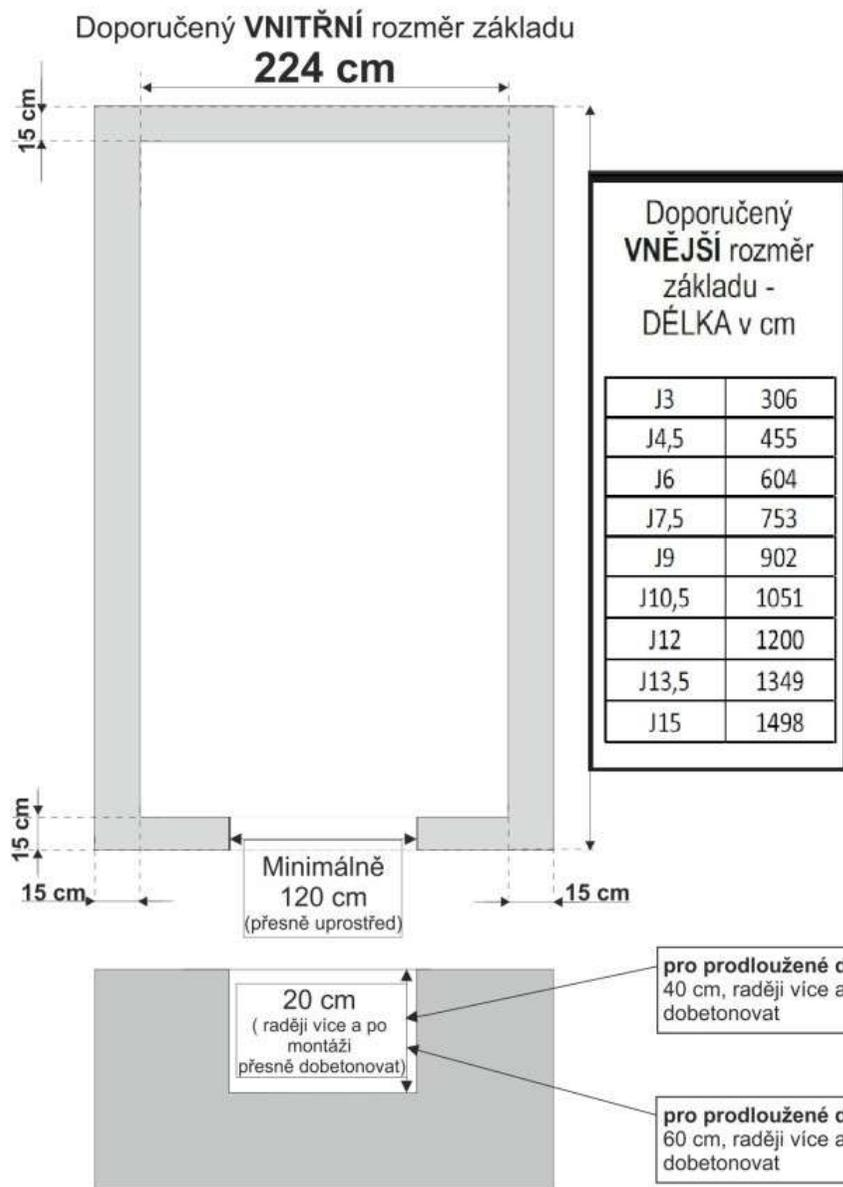
Doporučujeme pevně betonové základy ( lze použít i ztracené bednění). Pouze v případě řádného ukotvení skleníku k pevným základům lze dát plnou garanci za stabilitu skleníku dle statických výpočtů.
