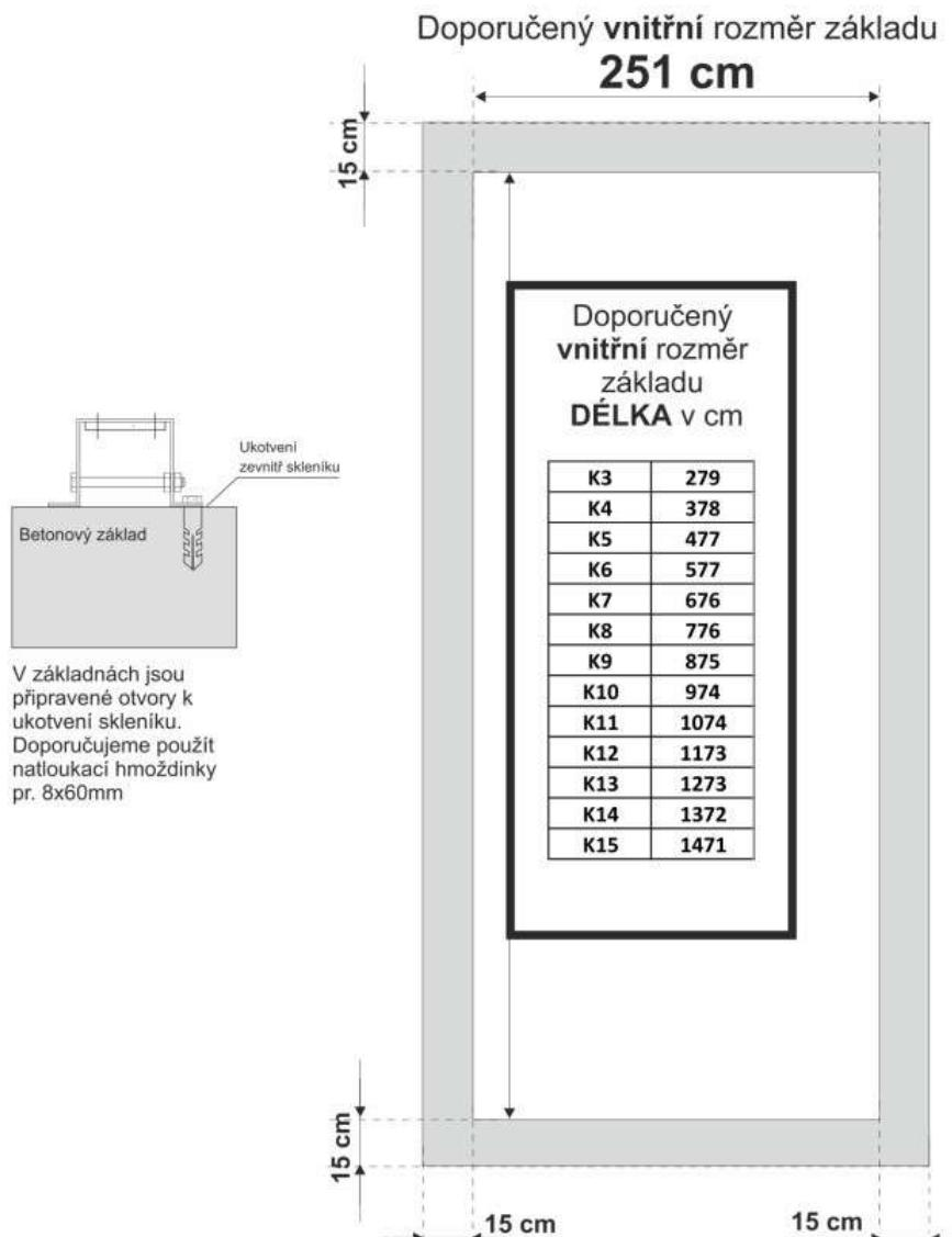
Doporučujeme pevné betonové základy ( lze použít i ztracené bednění). Pouze v případě řádného ukotvení skleníku k pevným základům lze dát plnou garanci za stabilitu skleníku dle statických výpočtů.
