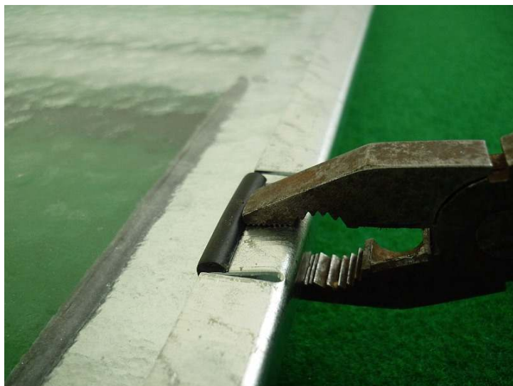
Pomocí kleští jemně přitlačíme příchytku (poz. 83-
