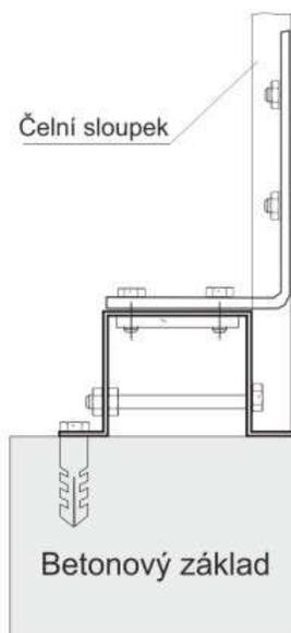
**POZOR při montáži zapuštěných dveří:** Vnější rozměry základů je **NUTNÉ** dodržet.
